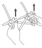
拇指上推旋锁爪，即可将高度升高。调高时无需按压高度调节按钮。
