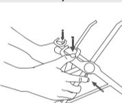
Při prvním otevření stojanu je výška nastavena na nejvyšší úroveň. Stiskněte Pák pro Nastavení Výšky a současně zatlačte na Uzámykací Svorky dolů, aby nastavili požadovanou výšku.
