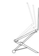
Insérez l'extrémité avant du châssis dans les Pinces de Verrouillage et placez l'ordinateur portable sur les Bras de Support.
