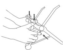
Al abrir por primera vez el soporte, la altura está en la posición más alta. Aprieta las Palancas de Ajuste de Altura y empuja hacia abajo las Abrazaderas de Bloqueo simultáneamente para ajustarlo a la altura deseada.
