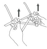
Empuja las Abrazaderas de Bloqueo hacia arriba para elevar la altura. No es necesario apretar las palancas.
