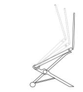
シャーシの前端をロッキングクランプに挿入し、ノートパソコンをサポートアームに置きます。
