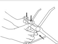
Quando si apre per la prima volta il supporto, l'altezza è impostata al massimo livello. Stringi le Leve di Regolazione dell'Altezza e spingi contemporaneamente verso il basso i Morsetti di Bloccaggio per regolare l'altezza desiderata.
