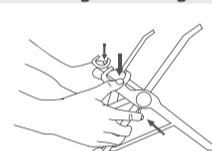
Bij het eerste openen van de standaard is de hoogte ingesteld op de hoogste stand. Knip in de Hoogteverstellhendels en duw tegelijkertijd op de Vergrendelingsklemmen om de gewenste hoogte in te stellen.
