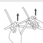
Schieben Sie die Verriegelungsklammer nach oben, um die Höhe zu erhöhen. Das Drücken der Hebel ist nicht erforderlich.
