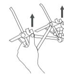
Poussez les Pinces de Verrouillage vers le haut pour augmenter la hauteur. Il n'est pas nécessaire de presser les leviers.
