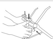
Beim ersten Öffnen des Ständers ist die Höhe auf die höchste Einstellung eingestellt. Drücken Sie die Höhenverstellhebel und drücken Sie gleichzeitig die Verriegelungsklammer nach unten, um die gewünschte Höhe einzustellen.
