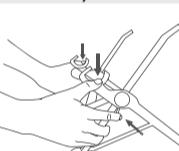
Przy pierwszym otwarciu stojaka, wysokość jest ustawiona na najwyższy poziom. Ścisnij Dźwignię Regulacji Wysokości i jednocześnie naciśnij w dół Zaciśki Blokujące, aby dostosować do żądanej wysokości.
