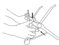
打开支架时，支架处于最高档。按压高度调节按钮，同时下压旋锁爪，可将支架调低到需要的高度。
