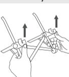
Podnieś Zaciśki Blokujące do góry, aby zwiększyć wysokość. Ścisanie dźwigni nie jest konieczne.
